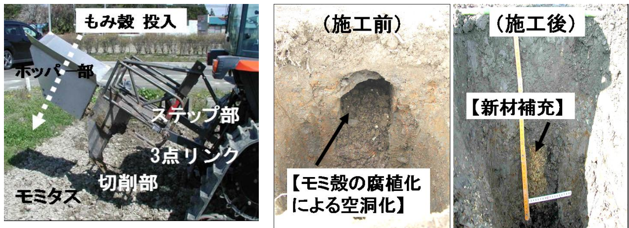
図1 もみ殻簡易開削充填機「モミタス」の構成と施工効果
