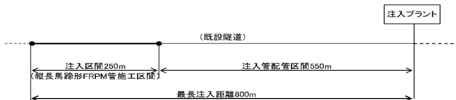
Fig. 5 中込材圧送距離概要図
