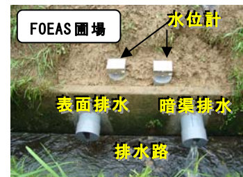
Photo 1 排水量調査状況
