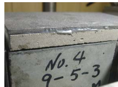
Fig.5 付着強度試験供試体
