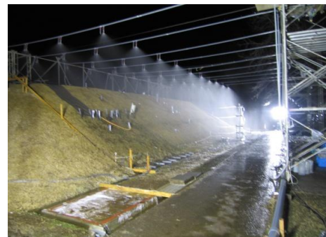
Fig.3 堤体表面被覆工法の降雨実験
