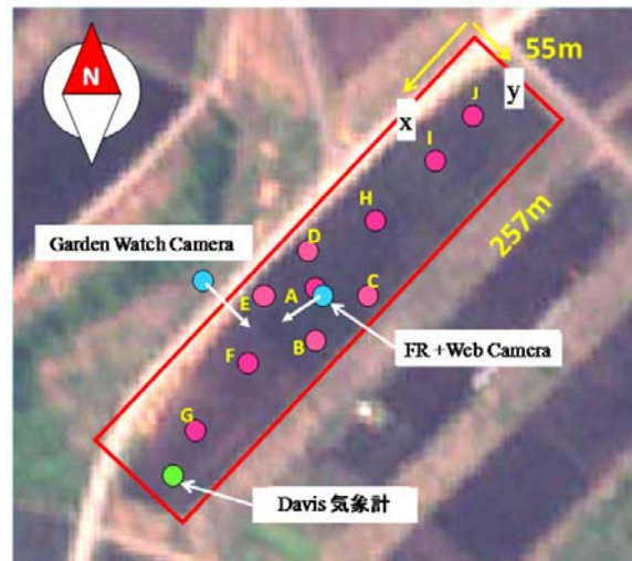
Fig. 1 現地の観測機器の配置図
