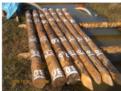
図1 試験に用いた木杭(松杭)
