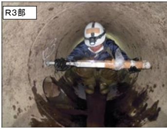
Pic.1 水平方向の管内径測定 Pic.2 管底部内面状況磨耗なし Pic.3 継手部隙間測定
