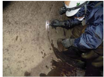
Pic.1 水平方向の管内径測定 Pic.2 管底部内面状況磨耗なし Pic.3 継手部隙間測定
