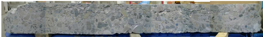
図-3 L型ブロック断面状況
