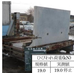
写真-3 試作した PCa 製品 PCa concrete trial product
