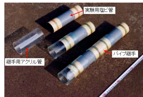
写真1 パイプライン継手の実験装置
