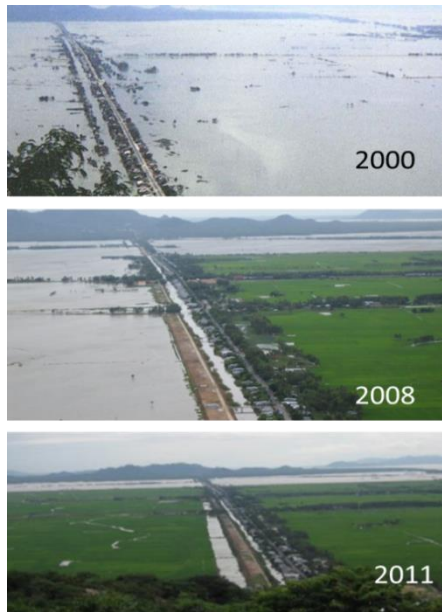
図1 セミダイクとフルダイク (上:両岸ともセミダイク、中:左岸セミダイク、右岸フルダイク、下:両岸ともフルダイク)
