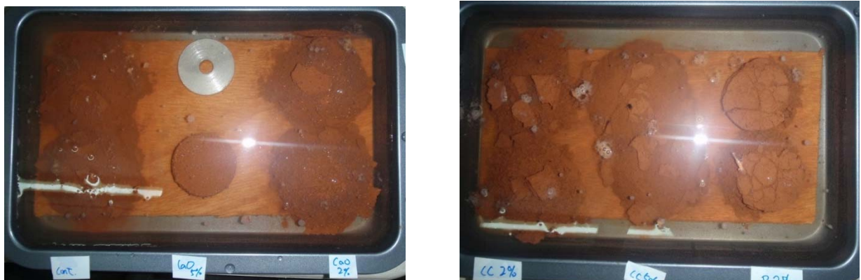
図 1 浸水試験状況(左から無処理、Ca05%、Ca02%、カカオ 2%、カカオ 5%、パーム 2%)
