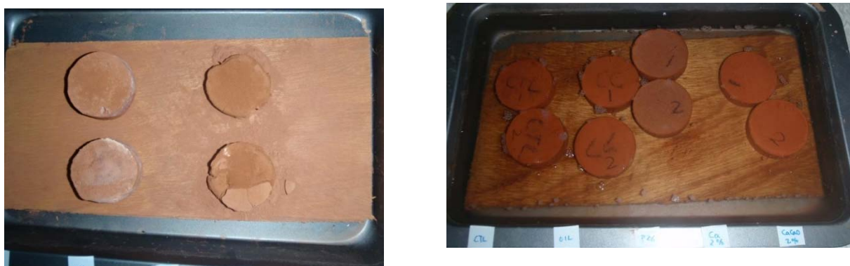
図 2 浸水試験状況(オイルを混ぜたもの) 図 3 浸水試験状況(軽焼したもの)
