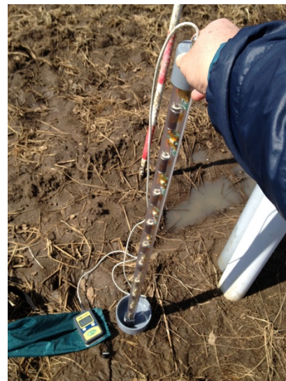
Fig. 2 土壌放射線測定器「長尺くん」
