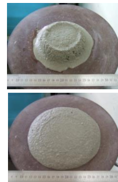
Fig.3 フロー試験の状況 (上: C0-P0, 下: C0-P10) The situation of the flow test (Up:C0-P0, Down:C0-P10)
