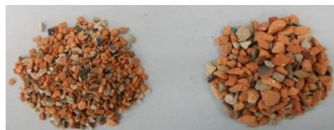
図 1 実験に用いた廃瓦骨材 Roof tile aggregate
