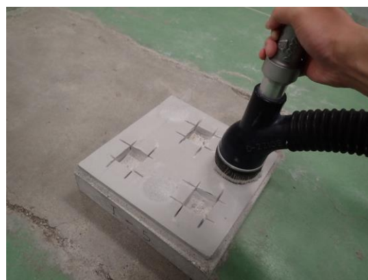
Fig.1 サンドブラスト法の試験状況 Test condition of sandblast method
