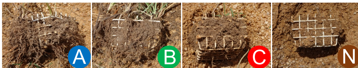
写真1. 引き抜き後の供試体 Test pieces pulled out (A, B, C, N from the left)
