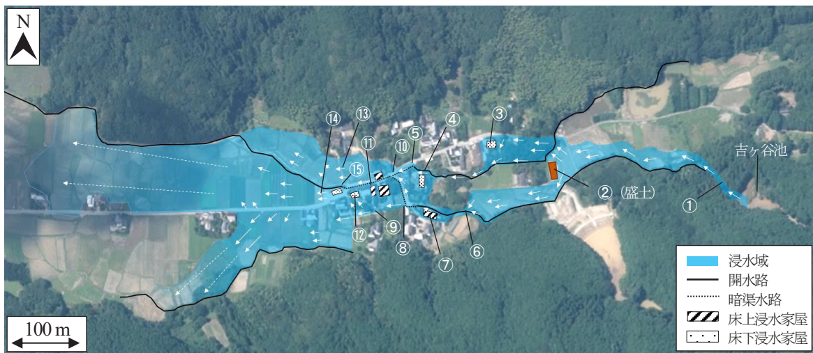
Fig. 2 吉ヶ谷池の決壊氾濫流況（背景は国土地理院空中写真；2017年7月13日撮影）
