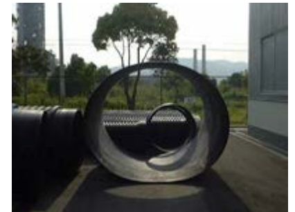
図. 大口径PE管の自重変形
