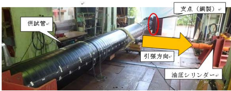
図. PE-GF 管 実物大による 3 点曲げ試験
