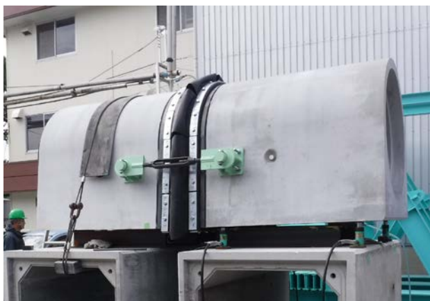
写真-1 継手部性能確認試験状況
