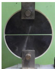
図 7 引張試験状況
