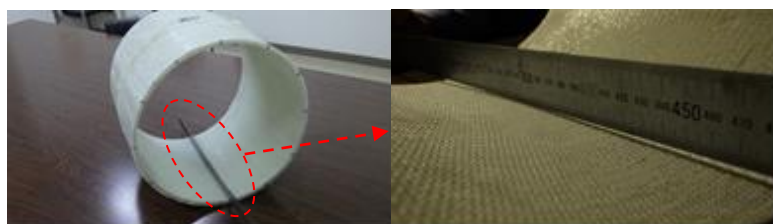
図 4 3°屈曲部の更生管内面
