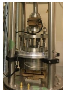
Fig.1 試験機全景 Fig.2 ロードセルとせん断リング
