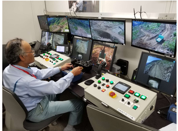
図-2 遠隔操作状況
