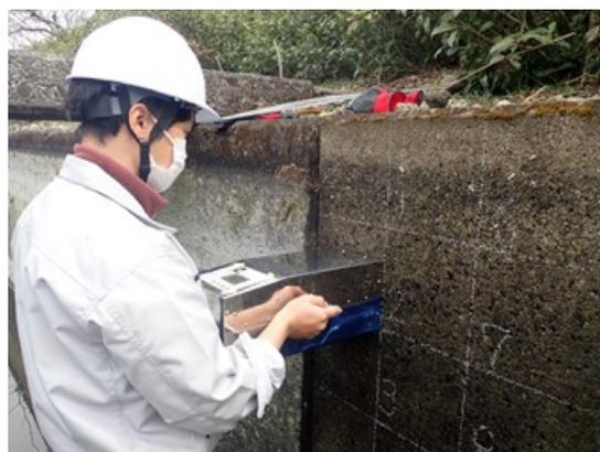
図 3. SODOTOR2000 計測方法
