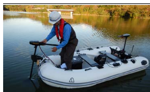
写真1 魚群探知機を用いた測深状況 Sounding using a fish finder
