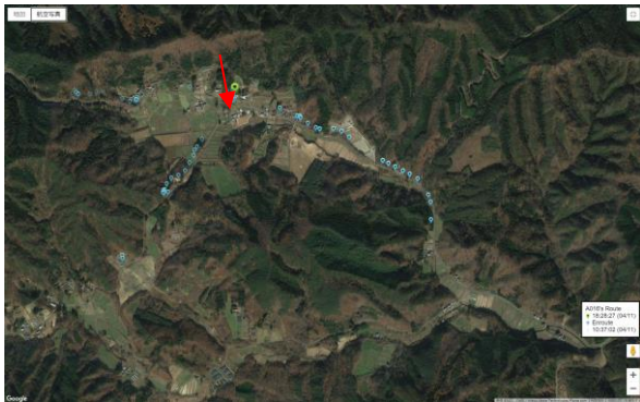
図4 LoRa電波の到達範囲（青色丸印）と親機の設置場所（矢印）
