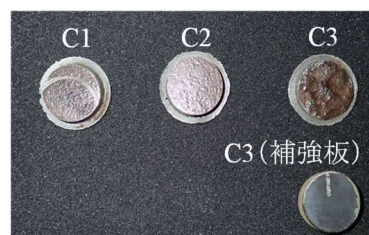
図 6 鋼矢板の腐食状況(鉄片試料)
