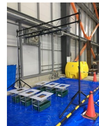
写真 2 降雨試験の状況 コンテナ設置 Rainfall test status, Container installation.
