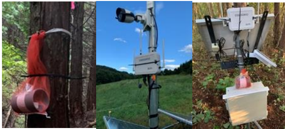
図4 温湿度センサユニット子機 (左)・プライベート LoRa ゲートウェイ親機 (中央)・中継器 (右)
