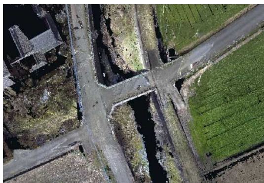
図1 西条市で取得した点群データ fig.1 Point cloud data acquired in Saijo City
