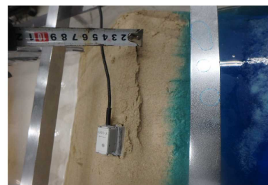
図-4 加振後の堤体状況 Embankments after shaking
