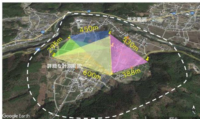
図2 マイクロフォンの設置位置 Location of 5 Sound Recordings Devices
