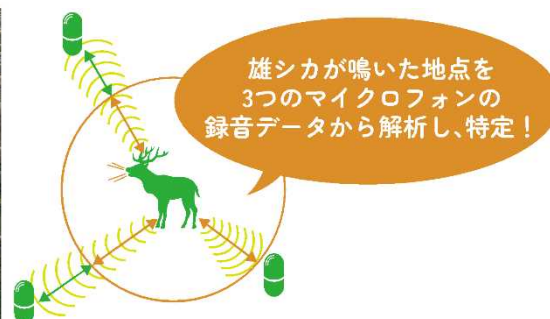
図2 マイクロフォンの設置位置 Location of 5 Sound Recordings Devices
