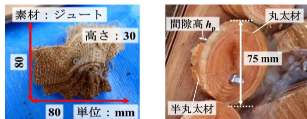
a) ジュート製ブロック b) 木製ブロック Fig. 1 ブロックの素材と形状 Material and shape of the block
