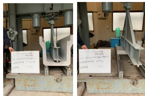
写真-1 PCa製品の曲げ試験状況
