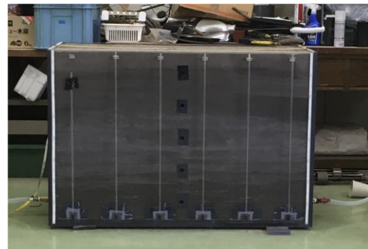
図 1 自由水面制御土槽（幅 120 cm，奥行 60 cm，高さ 80 cm）
