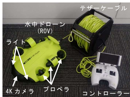
Fig.1 調査に使用した水中ドローン Underwater drone used for survey
