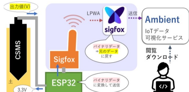
図 1 作成した土壌水分監視システム Fig 1 Soil Moisture Monitoring System
