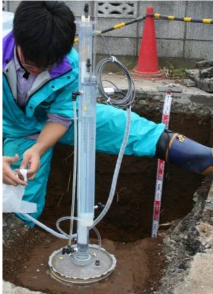
負圧浸入計を用いた 現場透水係数の評価
